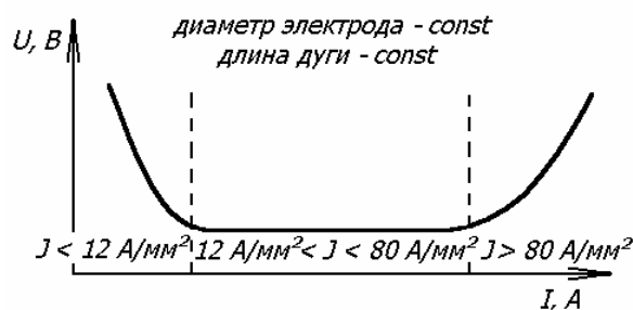
Рис. 5. Статическая вольтамперная характеристика электрической дуги.
