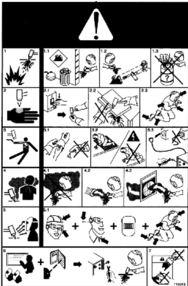
1. В процессе резки, искра может вызвать взрыв или огонь.
