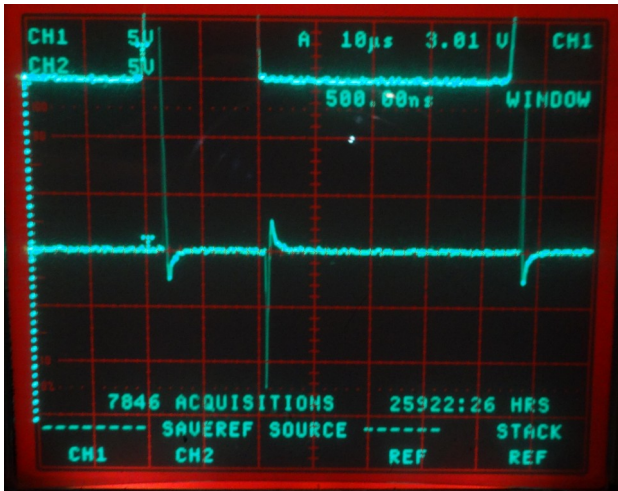
5 В/дел, 10 мкс/дел Верхний луч – входной сигнал Нижний луч – контрольная точка 13 в норме
