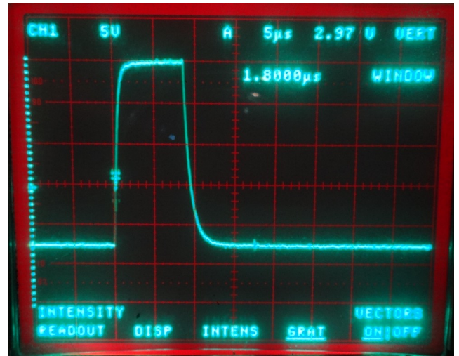
5 В/дел, 5 мкс/дел Выходной сигнал (вывод 3 разъема X2) при U_{CE} = 6 В (защита сработала)
