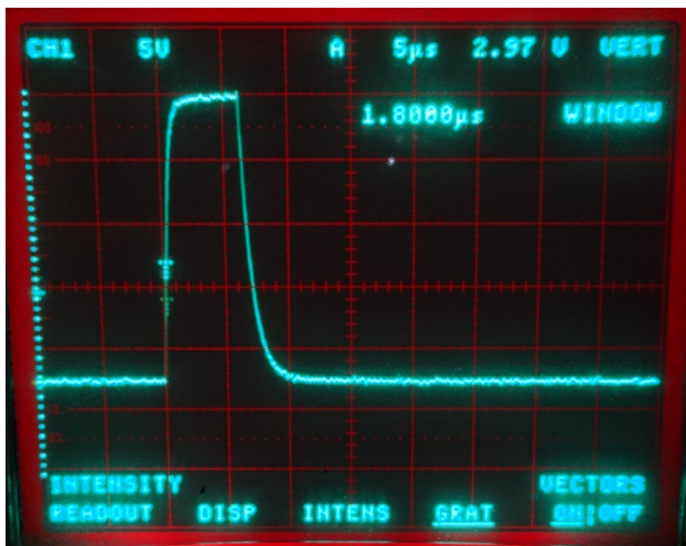
5 В/дел, 5 мкс/дел Выходной сигнал (вывод 3 разъема X2) при U_{CE} = 7 В (защита сработала)
