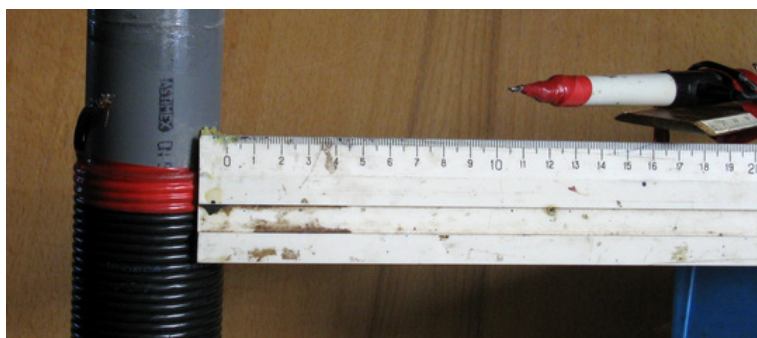
Рис. 8. Положение щупа осциллографа при снятии осциллограмм.
