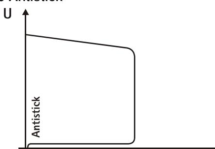
Устройство Antistick предотвращает прокаливание электрода.
