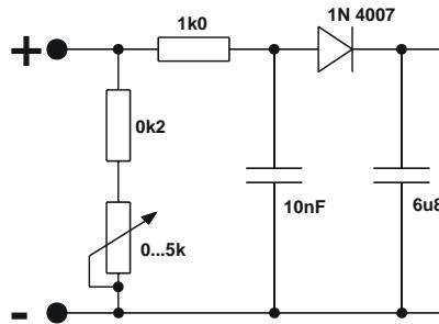
Подключите измерительную схему к клеммам сварочного тока. Вольтметр должен показывать средние значения и иметь внутреннее сопротивление  $\geq 1 \text{ M}\Omega$ . На аппаратах со ступенчатым переключением выставить максимальное выходное напряжение (переключатель ступеней). Во время измерения перевести потенциометр с 0 кОм на 5 кОм. Замеренное напряжение не должно отклоняться от указаний на заводской табличке более чем на +/- 5% и должно быть не более 113В (для приборов с VRD 35В).
