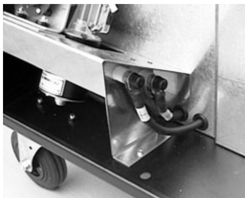
Abb. 5/3. Изменение полярности сварочного напряжения
