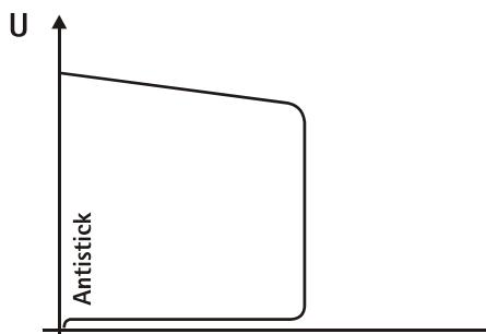
Устройство Antistick предотвращает прокаливание электрода.
