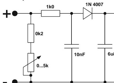
Подключите измерительную схему к клеммам сварочного тока. Вольтметр должен показывать средние значения и иметь внутреннее сопротивление  $\geq 1 \text{ M}\Omega$ . На аппаратах со ступенчатым переключением выставить максимальное выходное напряжение (переключатель ступеней). Во время измерения перевести потенциометр с 0 кОм на 5 кОм. Замеренное напряжение не должно отклоняться от указаний на заводской табличке более чем на +/- 5% и должно быть не более 113В (для приборов с VRD 35B).
