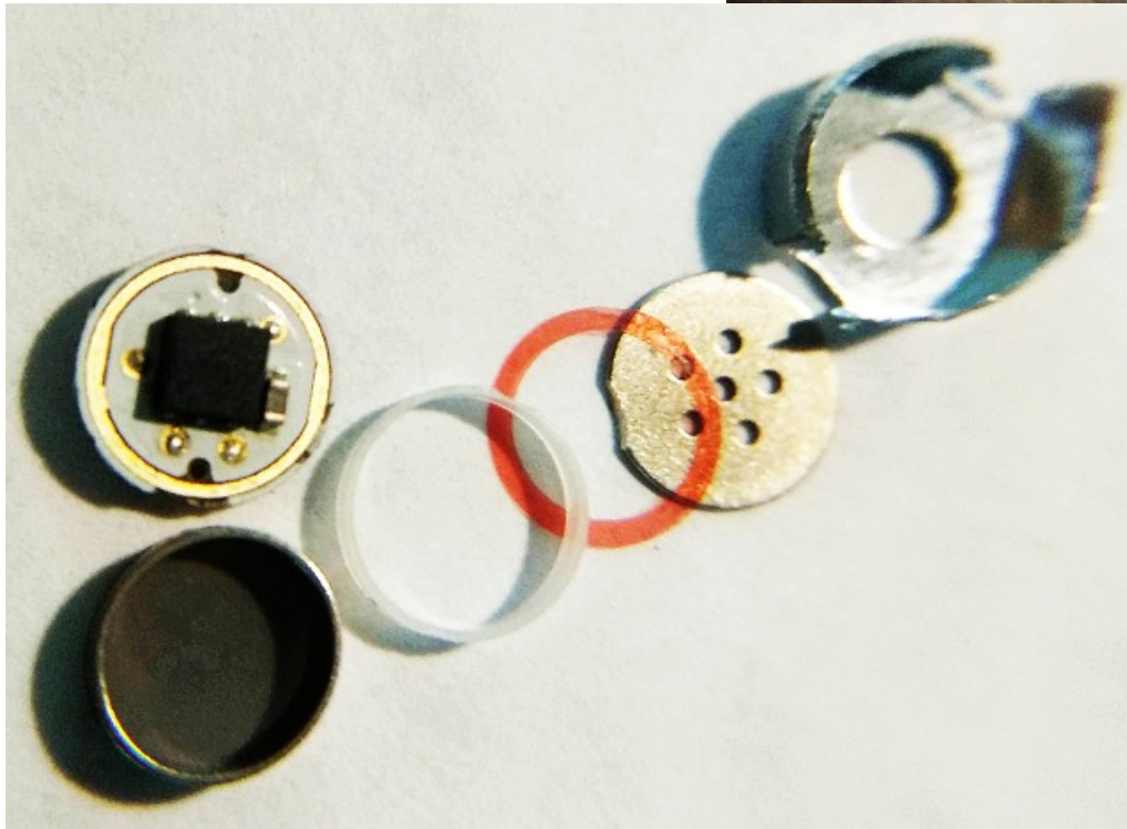
Сенсор в разобранном виде. Слева внизу эластичная токопроводящая мембрана.
