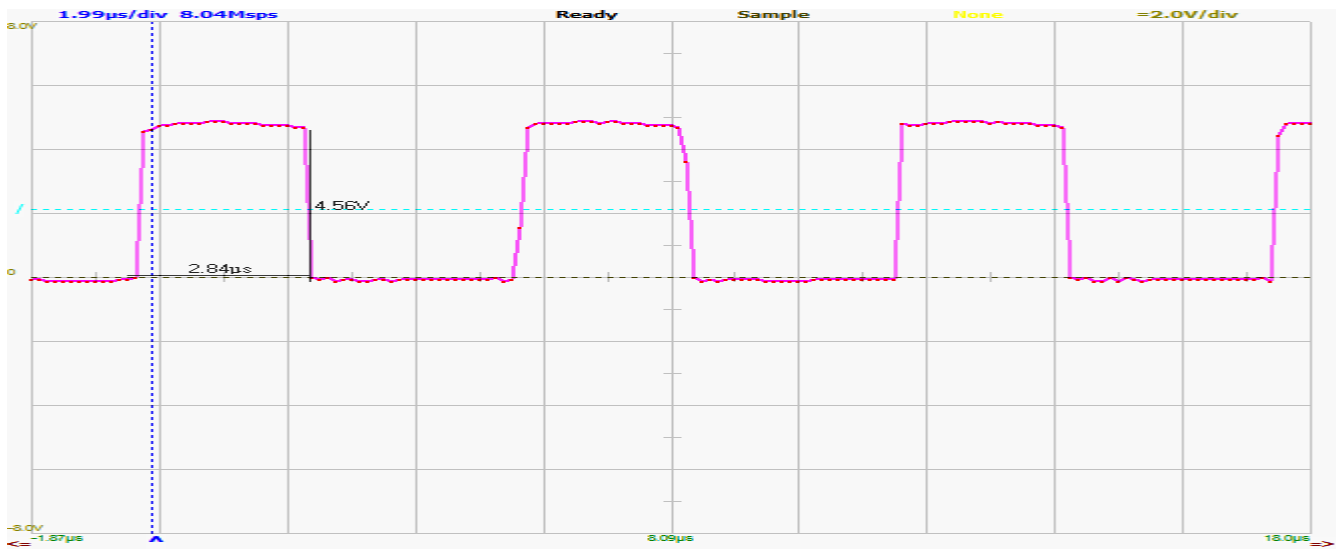
Выход контроллера U? (pin 6). Режим без нагрузки
